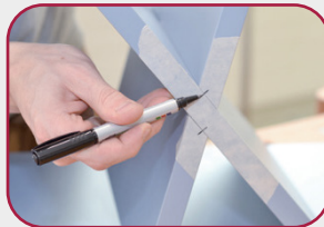
Пресликување на центарот за обработка на друга работна позиција
