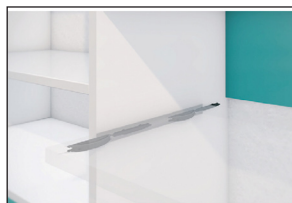
Лизгање на парчето се додека на се спојат двата дела од спојницата. ( клик систем )
