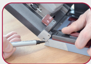
Маркирање и правење отвор за поставување на спојница.
