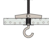
Стегање на типлата
