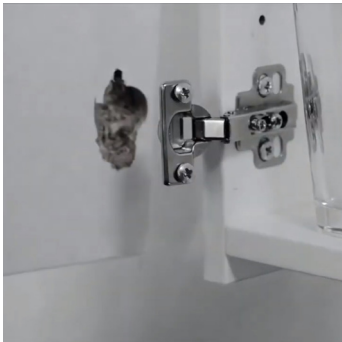
Оштетување на плочестиот материјал
