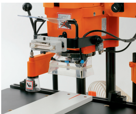
Точно маркирање со помош на ласер.
