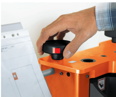
Брзо подесување на длабочина за бушење.
