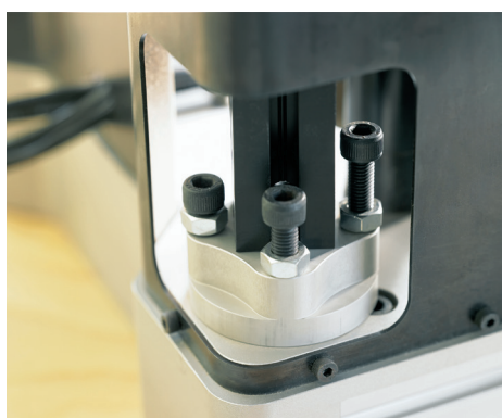
Едноставен начин за одредување на длабочината за бушење.
