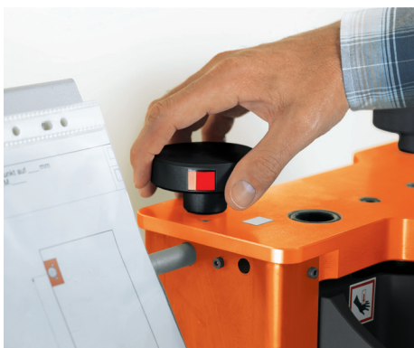
Брзо подесување на длабочина за бушење.
